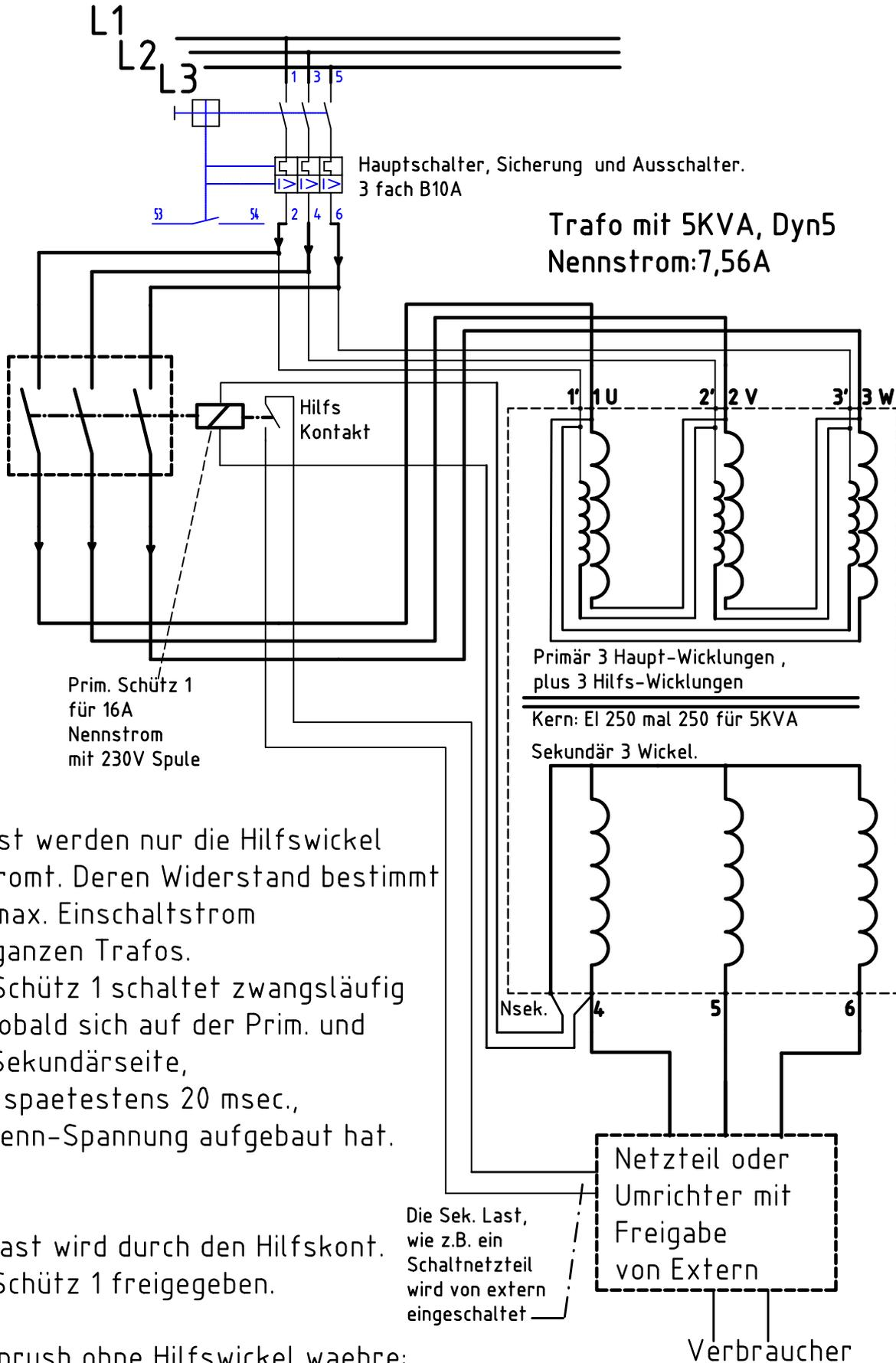
Zuerst werden nur die Hilfswickel bestromt. Deren Widerstand bestimmt den max. Einschaltstrom des ganzen Trafos. Der Schütz 1 schaltet zwangsläufig ein sobald sich auf der Prim. und der Sekundärseite, nach spaetestens 20 msec., die Nenn-Spannung aufgebaut hat.
