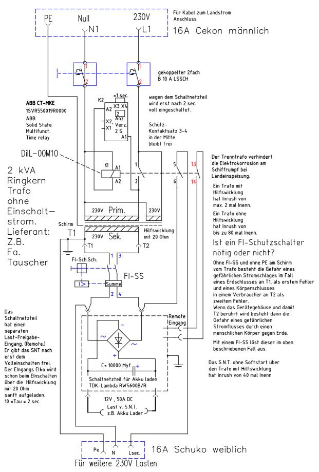
Schaltbeispiel für Schiffs—Trenntrafo und Schaltnetzteil ohne Einschaltstrom einschalten.
