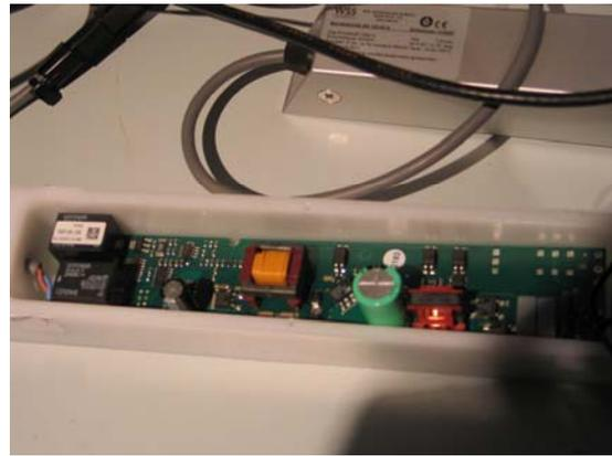
Schaltnetzteil im Kunststoffgehäuse, mit Schutzklasse 2.
