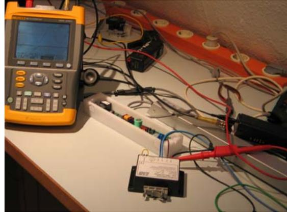
**Bild 5, mit dem Trafoschaltrelais, mit Option Nulldurchgangsschalter, läßt sich das Schaltnetzteil immer im Spannungsnulldurchgang einschalten.**
