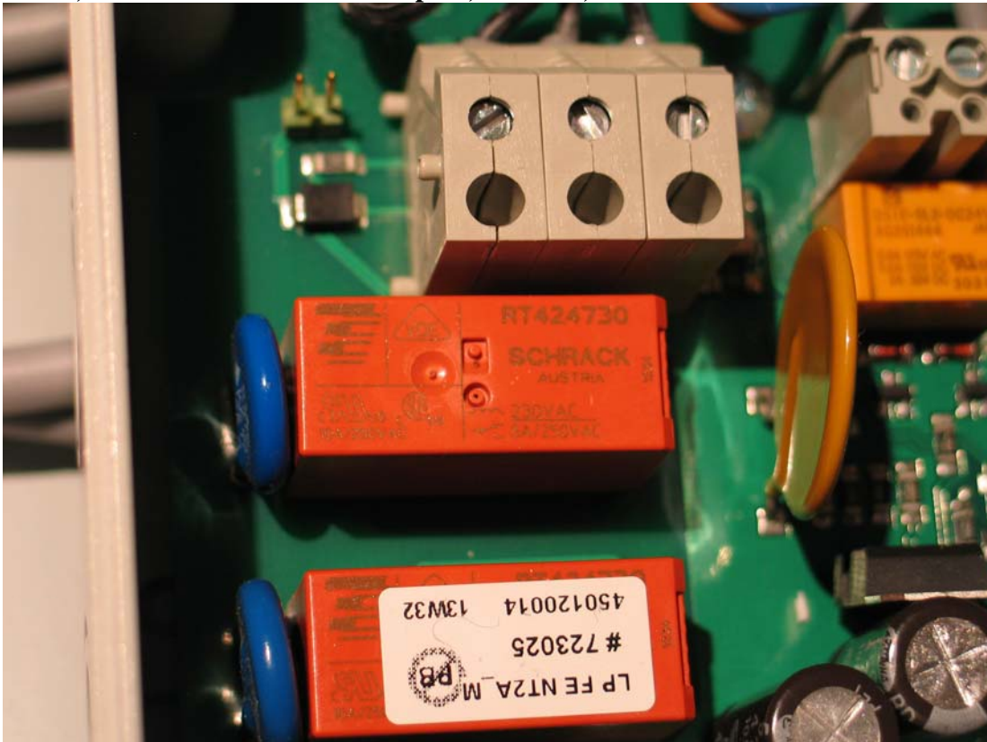
Jedes der orange farbigen Relais schaltet für eine der Laufrichtungen den Trafo ein. Der Trafo ist im Bild 19 abgebildet.
