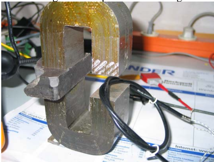
Bild 9: Magnet und Spulen Anordnung für Induktionsversuch 3.
