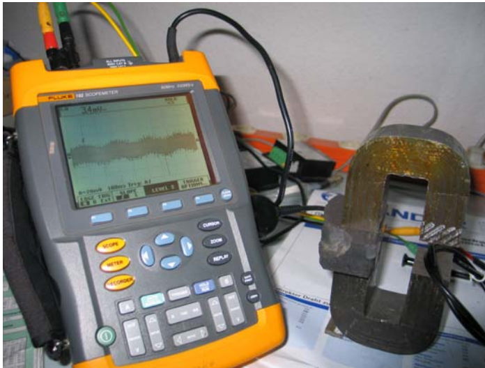
Bild 9: Magnet und Spulen Anordnung für Induktionsversuch 3.
