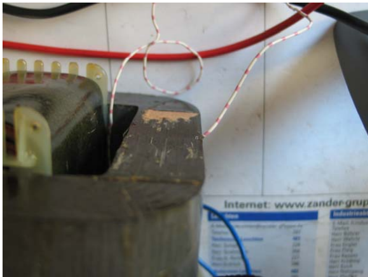
Bild 38: Neue Messung: Schleife kommt von links und geht geradlinig ganz rechts durch Kern zurück. Siehe Bild 40.
